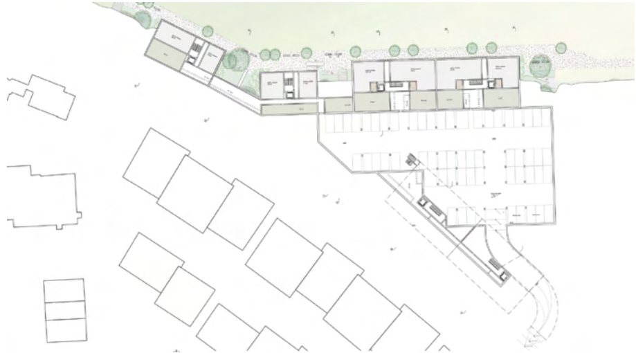
Abbildung 21 Grundriss Untergeschoss (Einstellhalle)
