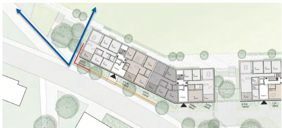
Abbildung 30: Ausschnitt Richtprojekt (Vollausbau) mit Abflussmöglichkeit im Hochwasserfall mit baulichen Massnahmen (rot) und/oder konzeptionellen Massnahmen (orange) sowie Abflussbereich (blau)
